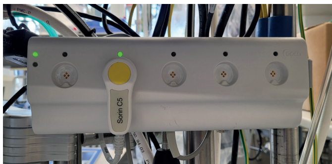
Abb. 1: CINDI-Box mit eingestecktem CINDI-Plug. Insgesamt verfügt eine CINDI-Box über fünf Steckplätze für die Anbindung verschiedener Geräte. Sobald ein Gerät über den Magnetstecker mit der CINDI-Box verbunden wird und ordnungsgemäß funktioniert, leuchtet die LED über dem Steckplatz grün. Bei Verbindungs- oder Softwareproblemen bleibt die LED ausgeschaltet bzw. leuchtet rot oder orange (Eigene Darstellung, 2025).
