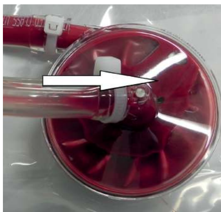
Abb. 2: Thrombus im Pumpenkopf
