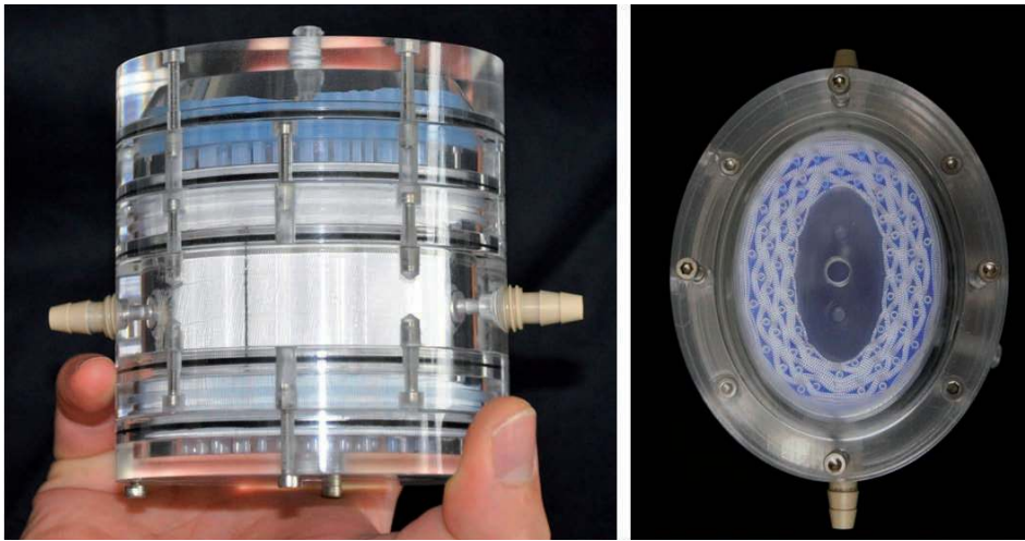
Abb. 2: Fotos des ExMeTrA Pump-Oxygenators; Seitenansicht (links) und Aufsicht (rechts): Zu erkennen sind die Silikon-Pumpschläuche in den blauen Feldern in der Aufsicht [5]
